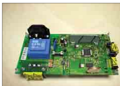
Рис. 2. Эталонная платформа однофазного многотарифного счетчика электроэнергии
