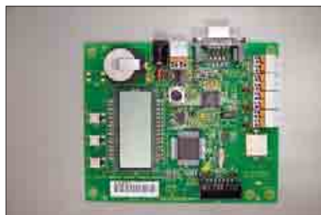
Рис. 3. Эталонная платформа измерителя сахара в крови
