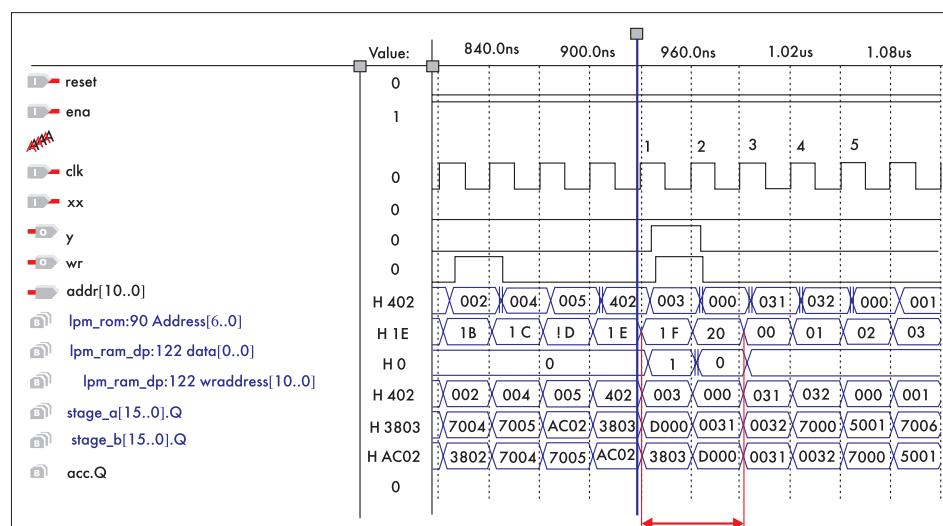
Рис. 4. Диаграмма работы микропроцессора для случая, когда команда перехода не выдается с упреждением
