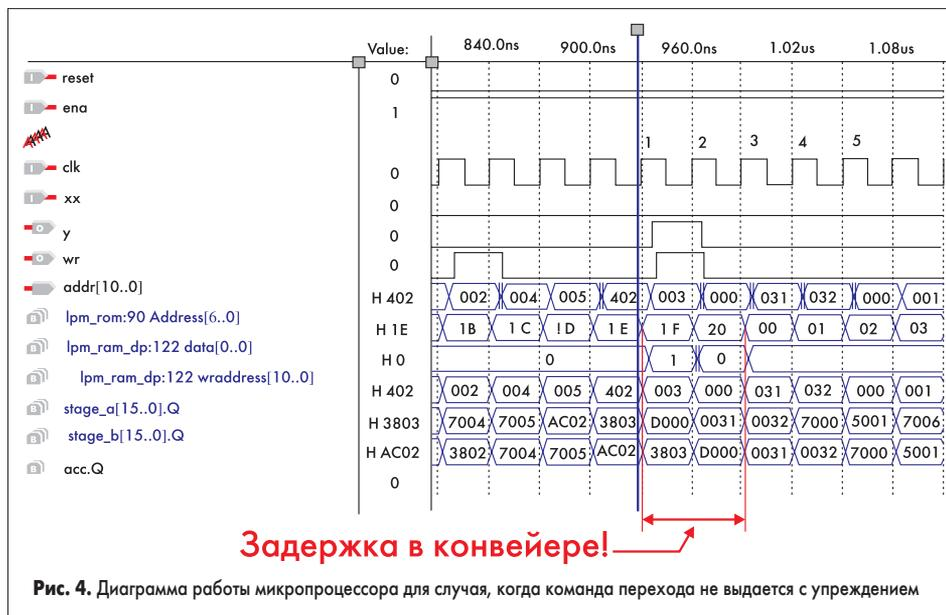
Рис. 4. Диаграмма работы микропроцессора для случая, когда команда перехода не выдается с упреждением
