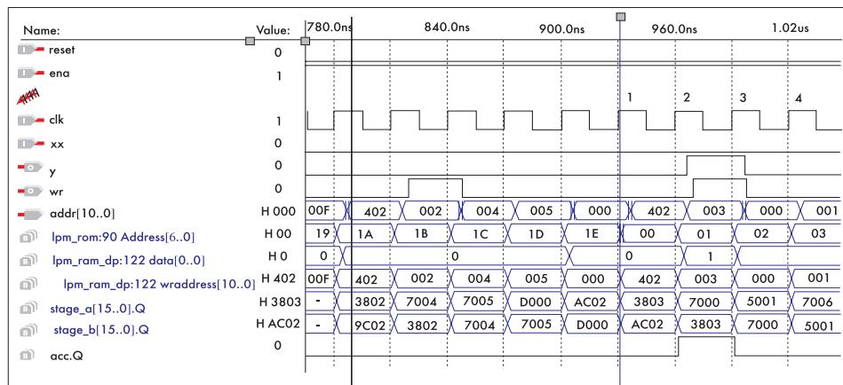
Рис. 5. Диаграмма работы микропроцессора для случая, когда команда перехода выдается с упреждением
