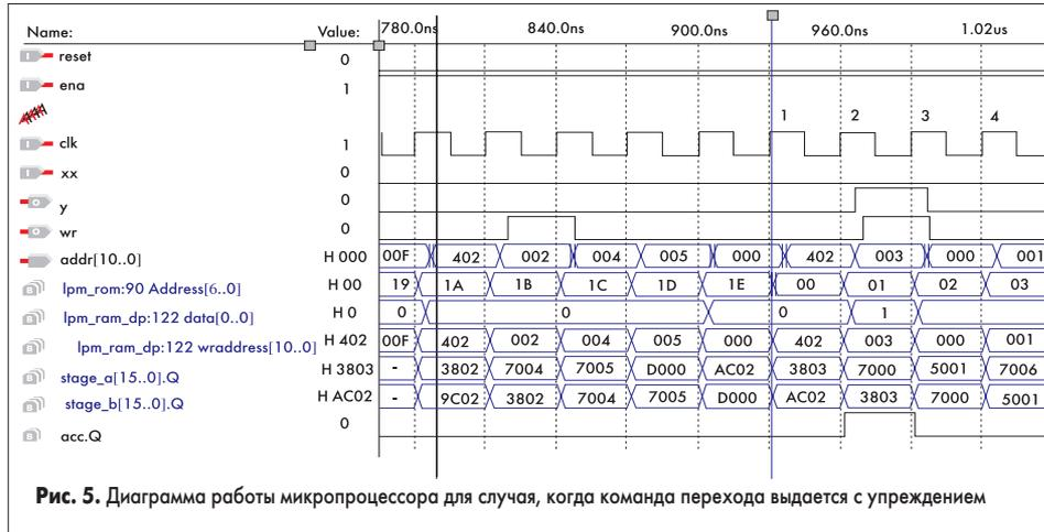
Рис. 5. Диаграмма работы микропроцессора для случая, когда команда перехода выдается с упреждением
