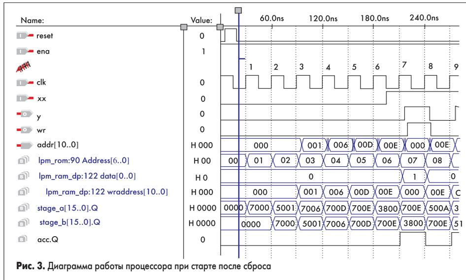
Рис. 3. Диаграмма работы процессора при старте после сброса
