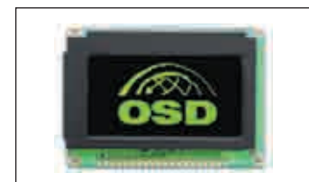
Рис. 20. Графический монохромный PLED-модуль формата 128×64
