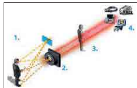
Рис. 82. Иллюстрация принципов работы 3D-камеры Canesta на основе технологии Electronic Perception Technology: 1 — невидимый источник света освещает объект; 2 — сенсорный чип измеряет расстояние, пройденное светом, до каждого пикселя датчика; 3 — уникальное встроенное программное обеспечение обработки изображений использует «карту глубины» для восприятия и идентификации объектов в реальном времени; 4 — устройство конечного пользователя адекватно реагирует
