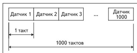
Рис. 1. Циклограмма поочередного обслуживания датчиков
