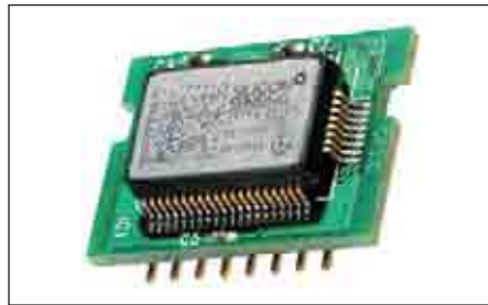
Рис. 2. Датчик угловой скорости CRS10 компании Silicon Sensing
