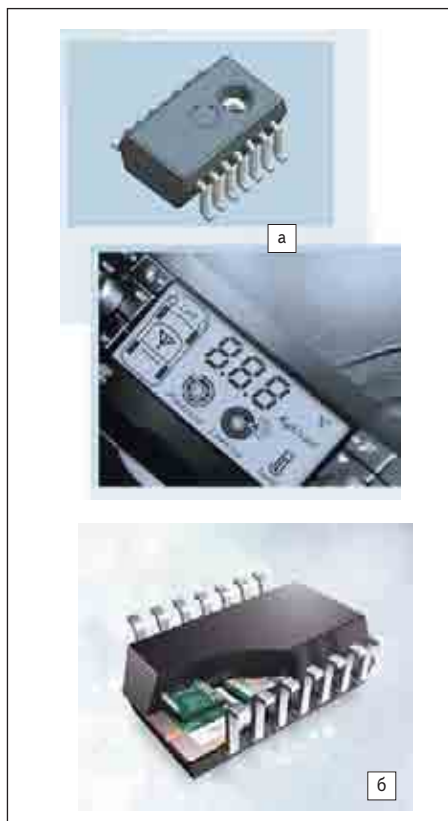
Рис. 88. Высокоинтегрированные датчики контроля давления в шинах для TPMS от Infineon: а) датчик SP30 Infineon с интегрированным микроконтроллером, LF-ресивером и акселерометром; б) датчик SP35 Infineon с интегрированным микроконтроллером, LF-ресивером, акселерометром и RF-трансмиссером
