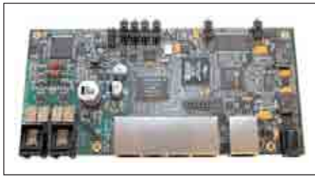
Рис. 5. Fusion Voice Gateway на базе процессора Blackfin от Unicoi Systems
