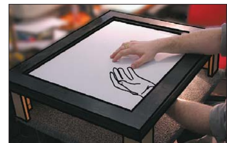
Рис. 14. Технология двойной чувствительности. Можно использовать жестовые манипуляции как над поверхностью стола, так и с его обратной стороны; в последнем случае на экране для обратной связи выводится контурное теневое изображение руки, находящейся под столом
