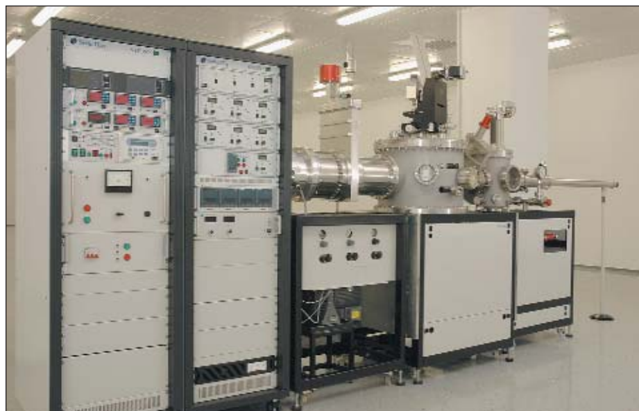
Рис. 3. Установка МПЭ нитридов третьей группы с использованием аммиака в качестве источника азота STE3N2
