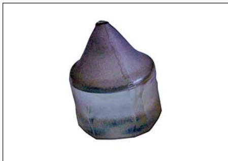
Рис. 6. Кристалл танталата лития, выращенный методом Чохральского
