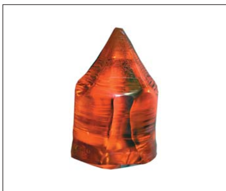
Рис. 5. Кристалл лангасита, выращенный методом Чохральского
