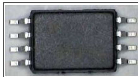
Рис. 2. Новые интегральные GMP-датчики Hitachi Metals
