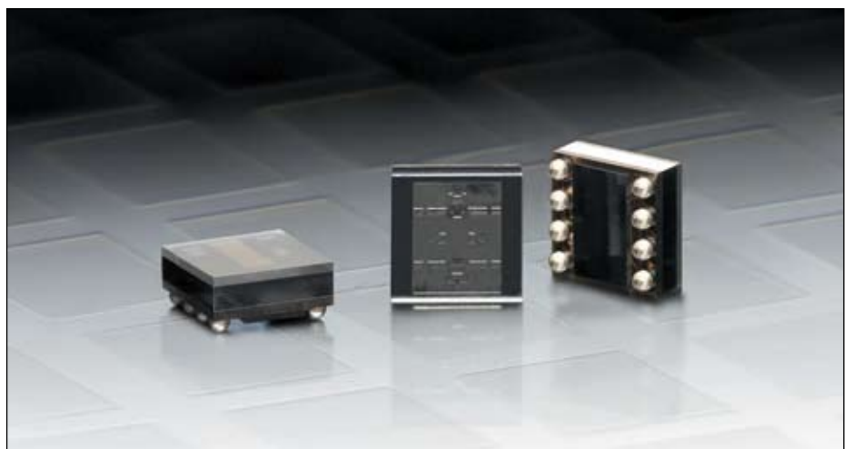
Рис. 11. СМА 3000 — трехосевой акселерометр VTI на основе технологии Chip-on-MEMS (CoM)
