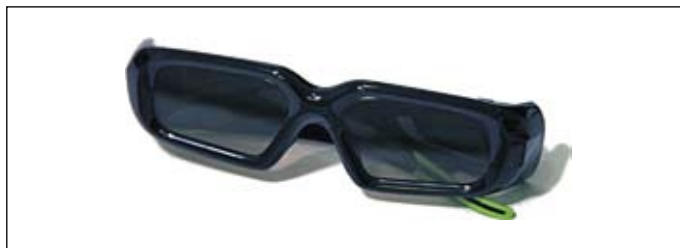
Рис. 12. Беспроводные активные поляризационные очки с ИК-интерфейсом
