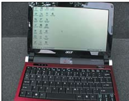
Рис. 2. Дисплей Pixel Qi в новой модели ноутбука Acer (режим e-paper)
