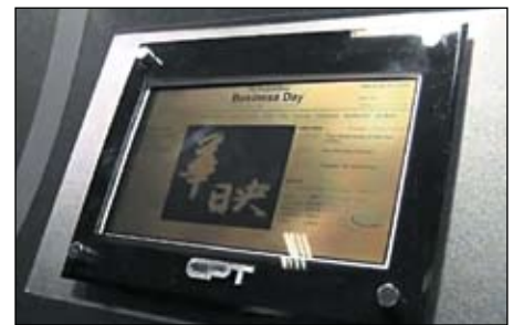
Рис. 5. Трансфлективный двухрежимный дисплей компании CPT
