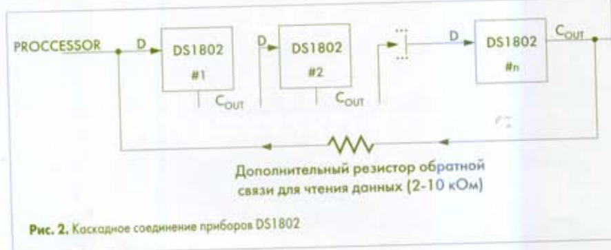
Рис. 1. Блок-схема цифрового потенциометра DS 1802
