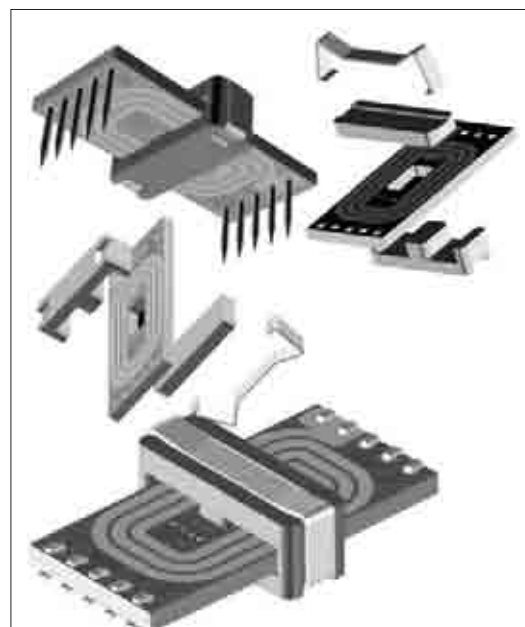
Рис. 1. Вид планарных трансформаторов с Ш-образным сердечником
