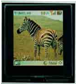
Рис. 6. Опытный образец 2-дюймовой панели (176×192 точек) с использованием CGSI, предназначенный для мобильных телефонов третьего поколения (Tohoku Pioneer)
