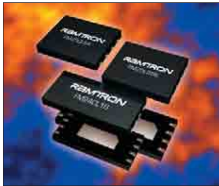
Рис. 2. Малогабаритные корпуса DFN
