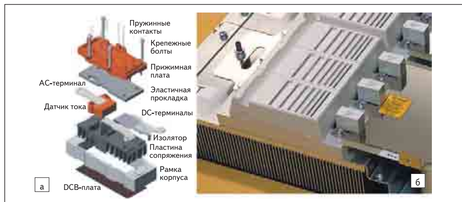
Рис. 1. а) Прижимная конструкция модулей SKiiP; б) параллельное соединение полумостовых элементов SKiiP
