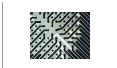
Рис. 20. Гибкая плата используется в датчике, с помощью которого формируется акустическое изображение объекта диагностики
