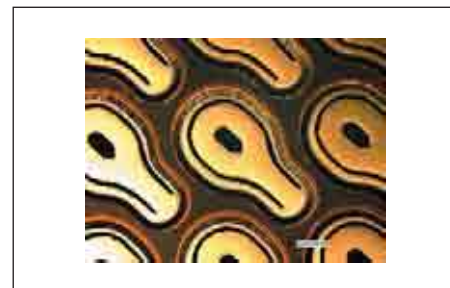
Рис. 22. Фрагмент монтажного поля для BGA-компонента
