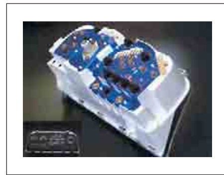
Рис. 21. Приборная панель автомобиля с монтажом с помощью гибких плат
