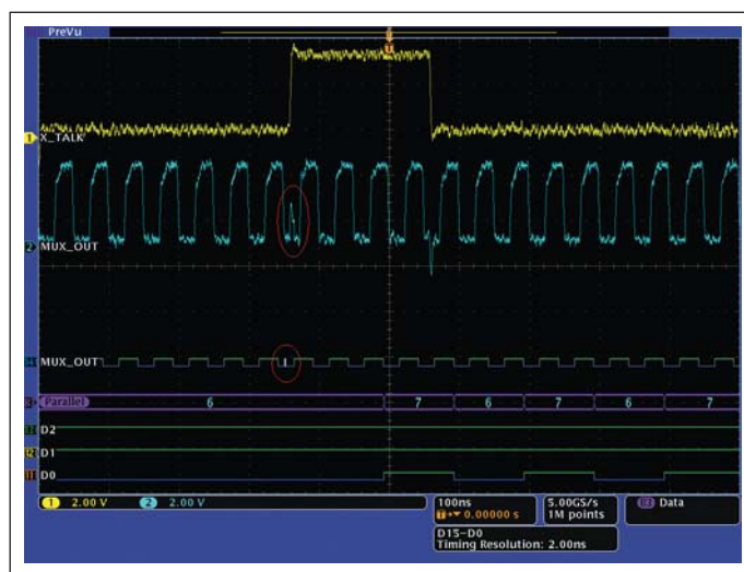
Рис. 8. Канал 1 показывает источник перекрестной наводки на сигнале MUX_OUT
