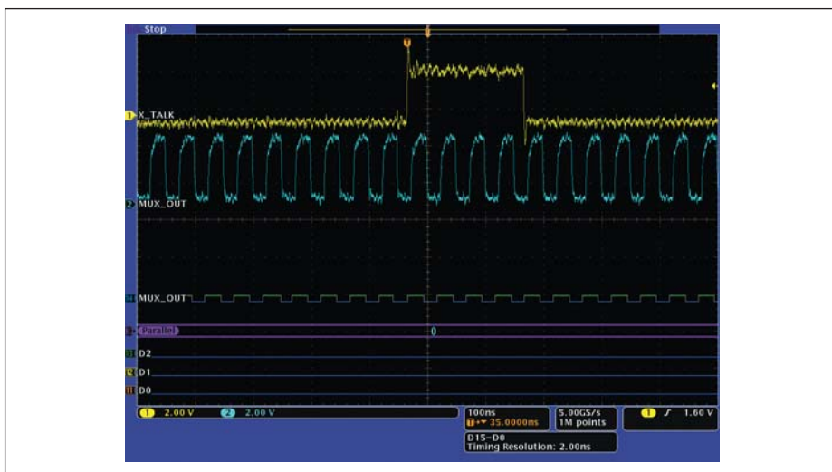
Рис. 9. Модификация печатной платы удаляет перекрестную наводку
