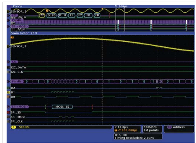
Рис. 4. Для масштабирования и детального просмотра передаваемых по шине пакетов используется Wavelspector
