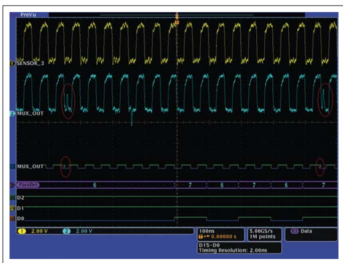
Рис. 7. Канал 2 более детально отображает MUX_OUT
