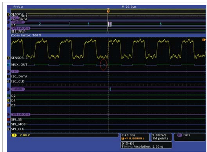
Рис. 6. WaveInspector позволил обнаружить глитч на сигнале MUX_OUT
