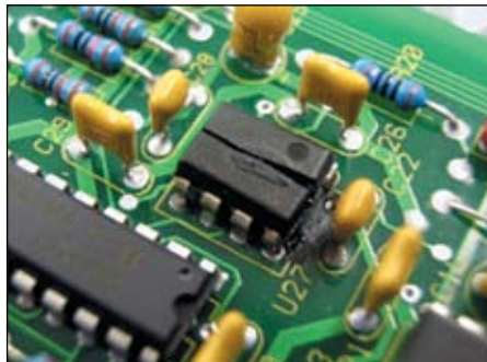
Рис. 2. Поврежденная интегральная схема после электрической перегрузки
