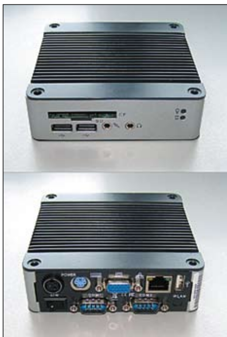
Рис. 1. Внешний вид встраиваемого компьютера eBox-3300
