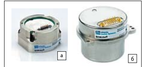
Рис. 9. Новое поколение кремниевых МЭМС IMU AIS с высокими рабочими характеристиками: а) SiIMU02 — прочное герметичное устройство для военных применений; б) SiIMU04 — IMU, дополненный двухосевым инклинометром
