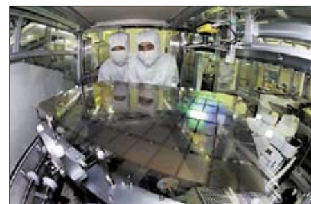
Рис. 3. Технологическая линейка компании SMD по выпуску AMOLED для мобильных телефонов
