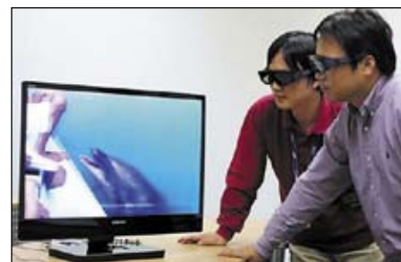
Рис. 7. 3D AMOLED телевизор Samsung (для наблюдения объемного изображения требуются специальные очки)
