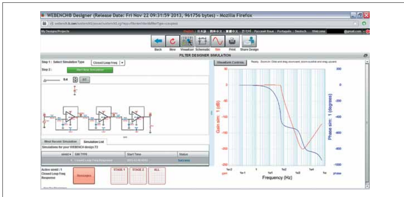
Рис. 12. Окно электрического моделирования фильтра: красная кривая — усиление; синяя кривая — фазовая характеристика
